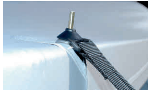
▲ De banden worden met een kunststof adapter op de framepenen bevestigd.
