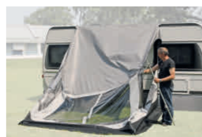
▲ Stap 4: Dakligger inschuiven.
