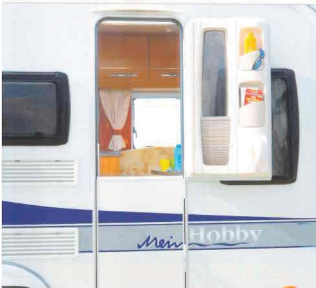
Tweedelige buitendeur met geïntegreerd raam, opbergvakken en antimuggenplissé
