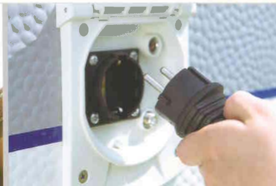
Voortent-buitenstopcontact (230 V-aansluiting, satelliet- en TV-aansluiting), (modelafhankelijk)
