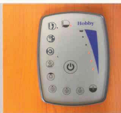
Bedieningspaneel voor verlichtingssys- teem en waterstandaanduiding
