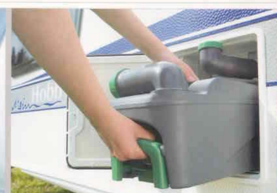
THETFORD-cassettetoilet met elektrische spoeling
