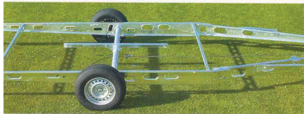
Staal torsie-geveerde-as (systeem Porsche), gegalvaniseerd chassis
