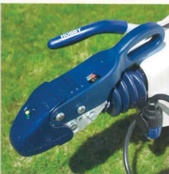
Stabilisatorkoppeling en oploopremsysteem met terugrijautomaat
