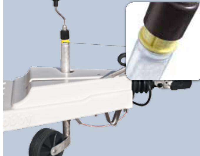
Dissel met afdekking en geïntegreerde kogeldrukmeter
